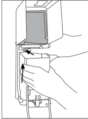
Deckel öffnen, Federzunge drücken, und Behälter nach oben herausnehmen.
