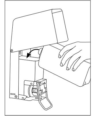
Behälter mit geeignetem Medium auffüllen und Deckel schließen.
